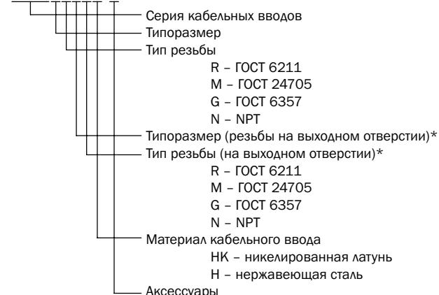
\* Код типа внешней резьбы не указывается, если она совпадает с внутренней резьбой. Типоразмер внешней и внутренней резьбы совпадают.
