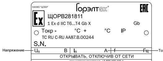
Технические данные (напряжение, ток или мощность и прочее), требуемые нормативной и технической документацией, можно найти на маркировочной табличке или в сопроводительной документации в случае малогабаритного оборудования
