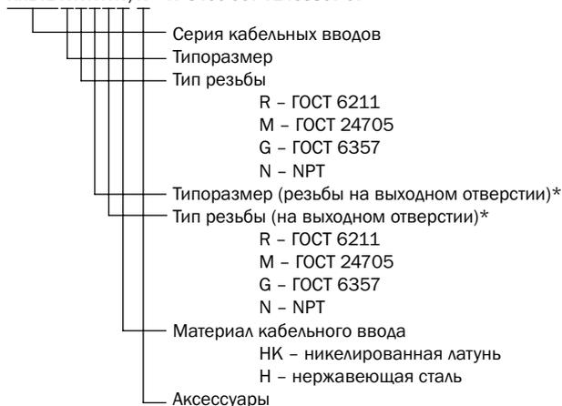
\* Код типа внешней резьбы не указывается, если она совпадает с внутренней резьбой. Типоразмер внешней и внутренней резьбы совпадают.
