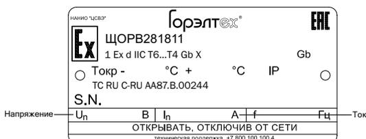
Технические данные (напряжение, ток или мощность и прочее), требуемые нормативной и технической документацией, можно найти на маркировочной табличке или в сопроводительной документации в случае малогабаритного оборудования
